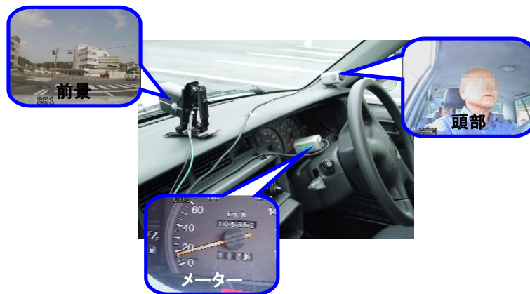
図3-1 前景用カメラ・頭部用カメラ・メーター用カメラの設置状況と映像(静岡)
