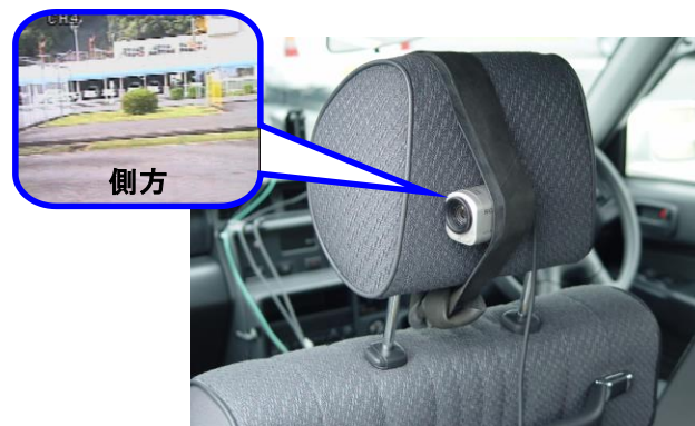
図3-2 側方用カメラの設置状況と映像(静岡)
