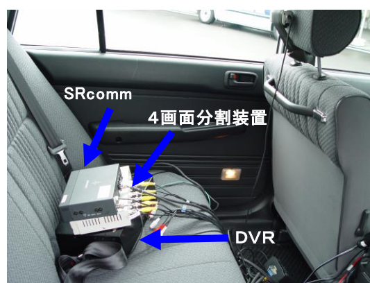
図 3 - 3 Srcomm、DVR と 4 画面分割装置の設置状況（静岡）
